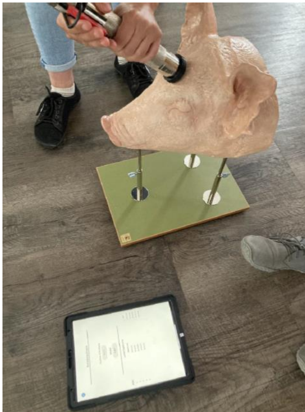
Abbildung 15 Anwendung des Bolzenschusssimulator
