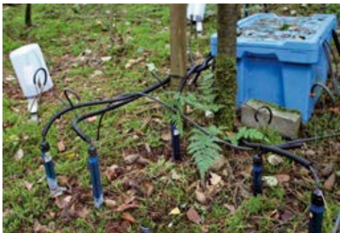
Tensiometer zur Messung der Bodenfeuchte
