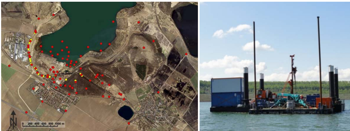
Bild 3 links: Bohrstandorte im und um den Concordiasee; Erkundungsbohrstandorte (rot), Brunnenbohrstandorte (gelb) (Orthophoto Stand: 29.03.2011) rechts: Erkundung auf dem Concordiasee vom Ponton aus
